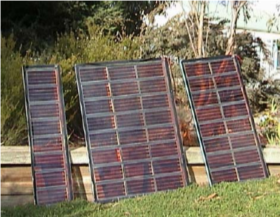
Australske DSC moduler til facadeintegration, effekten er ca. 50 W/m 2
